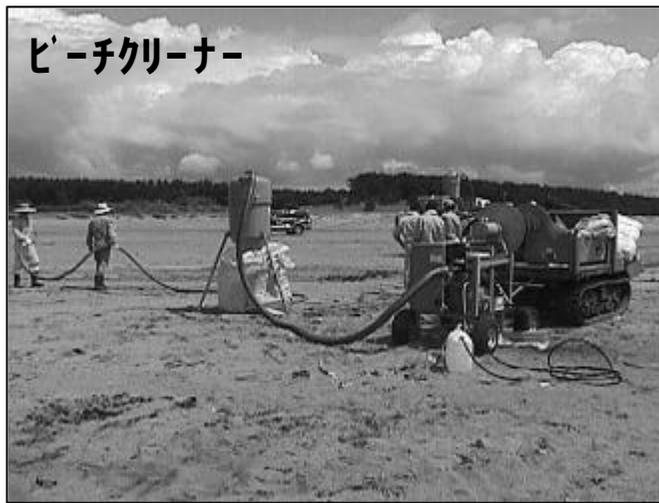
重機による回収作業
