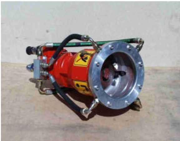
図 8 フレミング社製入口サイド蒸気・温水注水システム付き DOP ポンプ
