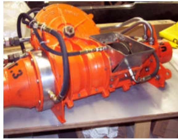
図 9 フレミング社製入口出口サイド蒸気・温水注水システム付き GT - 185 ポンプ
