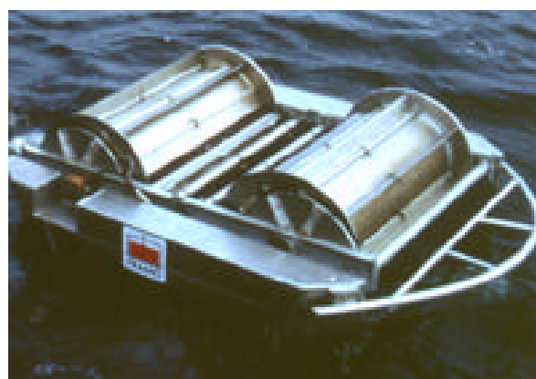
ダイナミック・ドライビングプレート 付きフラモ・ハイワックス・ツイン ドラム・スキマー
