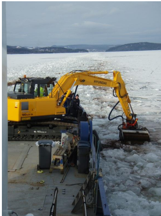
図 2. 油圧掘削機に接続された油回収バケット。2009 年に氷中でテスト (撮影: J. Pirttijärvi)
