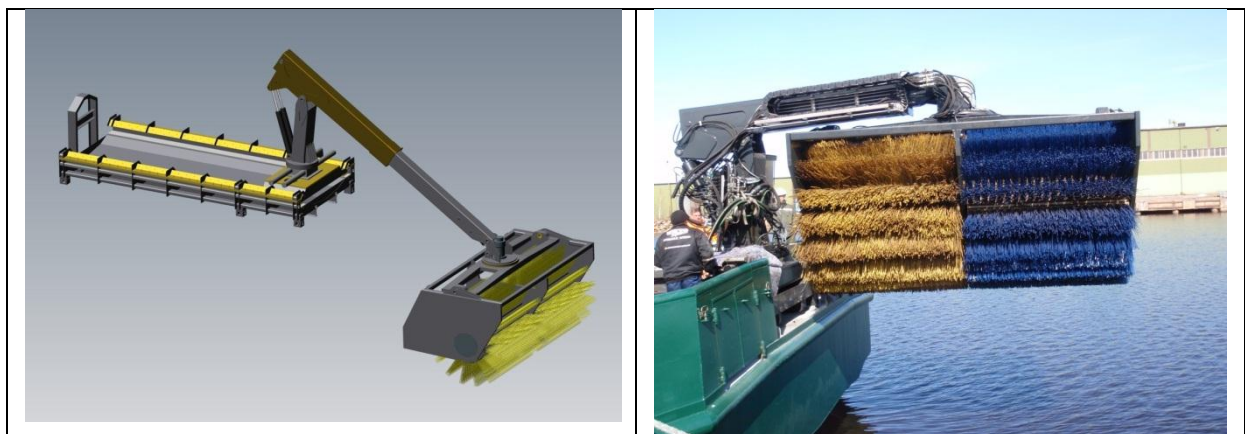
図 6. デザイン画像（左）と製造された試作機（開放水域でのテスト前）。
