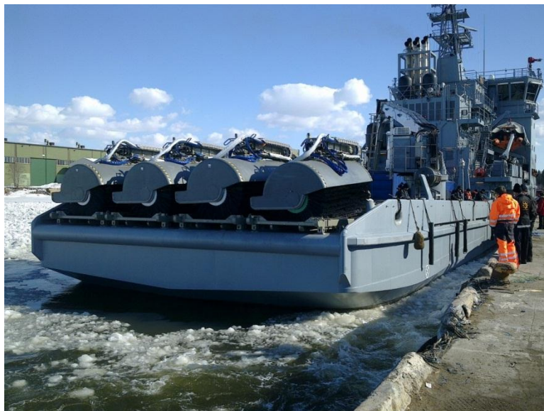
図 10. LOUHI の船尾デッキに搭載された輸送モードの油回収バケット (撮影 : J. Rytönen 2013)
