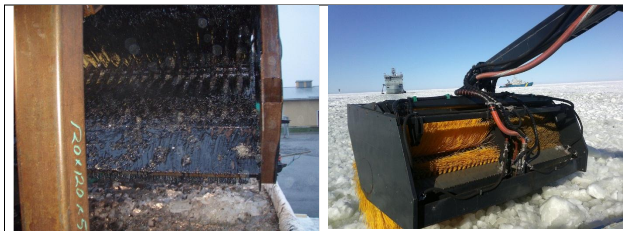
図 7. (左) 屋外実験室テストでの長さ 4000mm の試作機と (右) 実機規模の沖合演習での油回収ブラシ (長さ 4000mm、直径 2000mm)。
