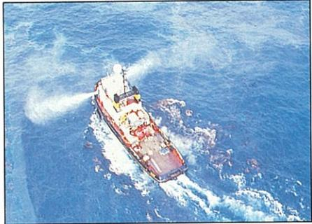
西アフリカ・ガボン沖における海上実験。油処理剤は、約5 - 10%の散布率で、軽質原油に対して船艇から散布されている。
