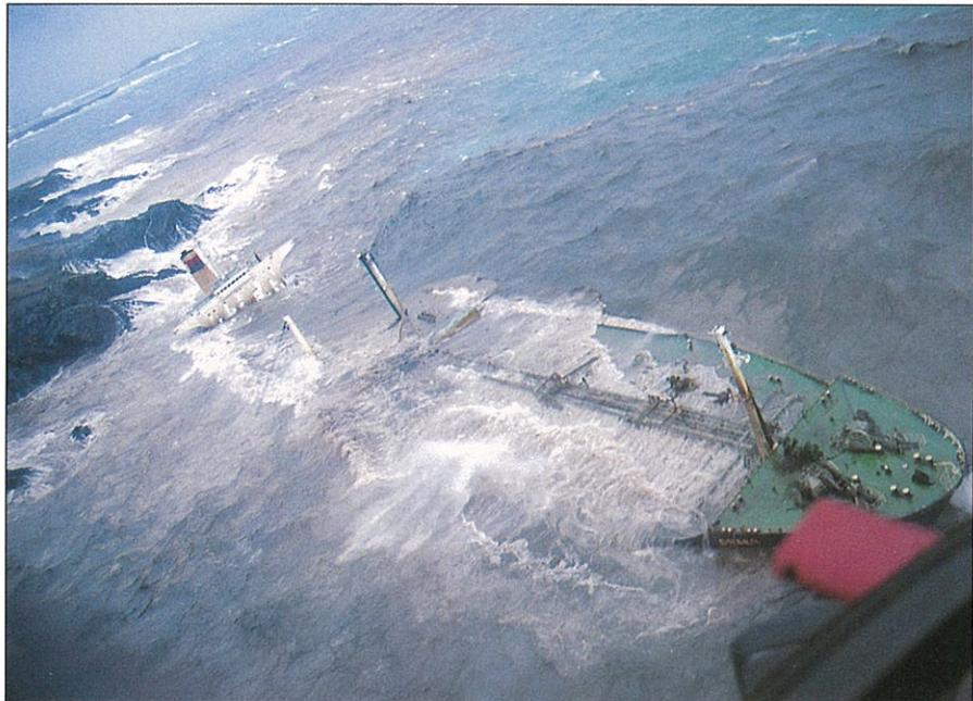
1993年1月、荒天候下のスコットランドのシェトランド諸島で、プレア号が座礁して85,000トンの積荷全量が流出した際、軽質原油が自然分散する可能性が実証された。天候がわずかに好転したとき、主に船の近くの油塊を処理するために、約120トンの油処理剤が空中散布された。
