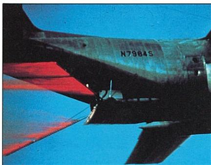
左：ADDSPACK(油処理剤空中散布装置)一翼に取り付け、取り外し可能な散布ブームによる散布装置
