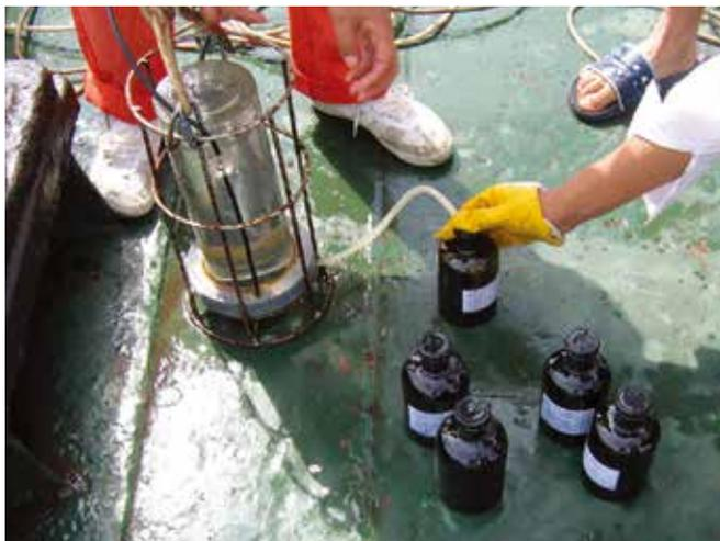
▲ 図8: 試料収集装置から海水試料を複数のガラス瓶に移しかえ、分割試料にしている。
