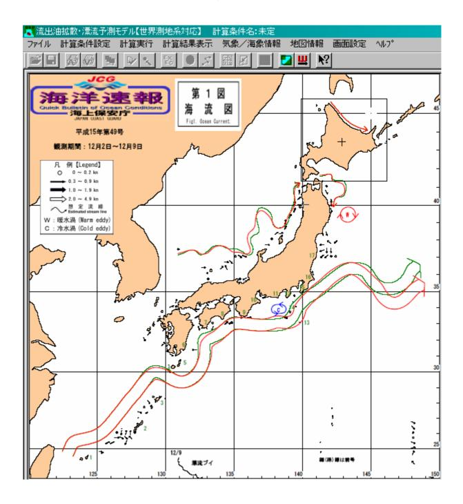
(5)正しく矩形が表示されている場合は[緯度と経度の設定ダイアログ]のOKを押してください。このように背景にビットマップが表示されますので、イメージデータ上で海流データがマウス入力可能となります。[海流データ作成ダイアログ]の[海流図消去]のボタンを押すと背景に表示されているビットマップが消去されます。
