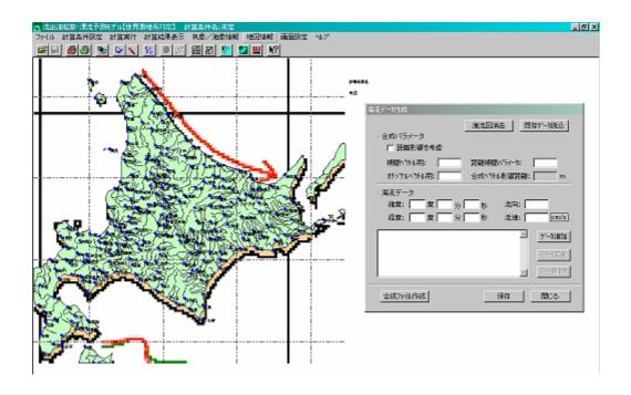
(6)保存後、「合成ファイル作成」ボタンを押すと表示されるメニュー内で合成用海流データファイルを選択し、「プレビュー」ボタンを押すと、合成後の海流データが表示されます。
