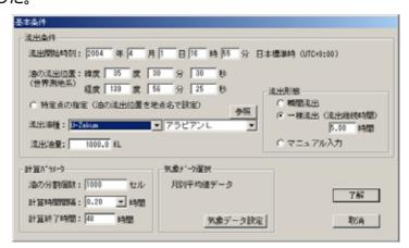
油の流出位置の緯度・経度データが日本測地系である場合、海上保安庁のサイトに掲載されているプログラムを使用して世界測地系の緯度・経度に変換して入力してください。なお、日本測地系と世界測地系では、東京付近では約 450m 程度のずれがあります。
