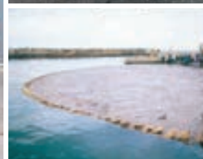
油捕獲材 オイルスネア (パーカーシステムズ社、米国)
