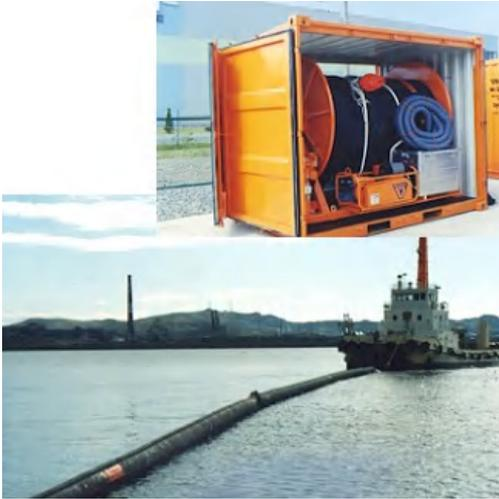
送風機で空気を浮体部に充填して使用。
