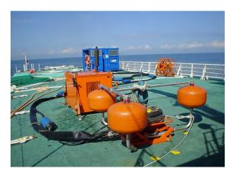
使用方法はDesmi 250と同様で、カッター付アルキメデスポンプは横置、回収能力約50kl/時。回収機本体、パワーパック、ホースなどの付属品とともにコンテナに収納(3.0m長×2.4m幅×2.6m高)、総重量約2.8トン。
