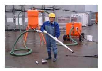
バキューム式の海岸漂着油回収用のクリーナー。吸引作業と同時に使用可能な高圧洗浄水用ポンプを装備。回収能力約30kl/時、動力はディーゼルエンジン。ビーチクリーナー一式(本体、油貯留ホッパー、ホース類などで構成)2組を専用コンテナに収納(3.0m長×2.4m幅×2.6m高)、総重量は4トン弱。あわせて同コンテナに木箱収納の仮設回収タンク8基を収納。
