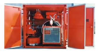
3個のフロートの中央部に位置するホッパー(漏斗)部分の、海水面に対する高さを調整して流出油を誘導し(リモートコントロール)、縦型に組み込まれたカッター付アルキメデス型スクリュー・ポンプによって、高粘性油を付着したゴミとともに吸引回収。回収能力約50kl/時程度。回収機本体、パワーパック、ホースなどの付属品とともにコンテナに収納(3.0m長×2.4m幅×2.4m高)、総重量約3.3トン。
