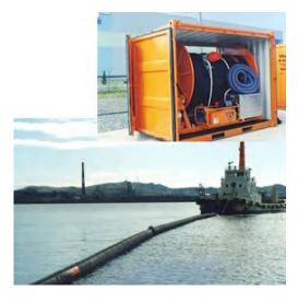
送風機で空気を浮体部に充填して使用。 寸法は海面上60cm、海面下90cm、重量は6kg/m。 ユニコン・ジョイント。 材質はナイロン、ネオプレン両面コート。 リール巻き250m単位で、 送風機などの付属品とともにコンテナに収納 (3.1m長×2.4m幅×2.6m高)、総重量約4.6トン。
