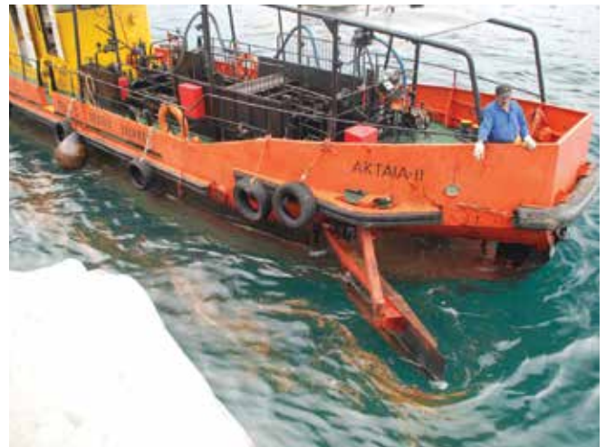
▲ 図1：港湾及び沿岸水域用の自走型堰式油回収機。船首扉が開いて掃海幅を広げ、浮遊油が入りやすくする。回収油は、内蔵の貯蔵タンクへ送られる。
