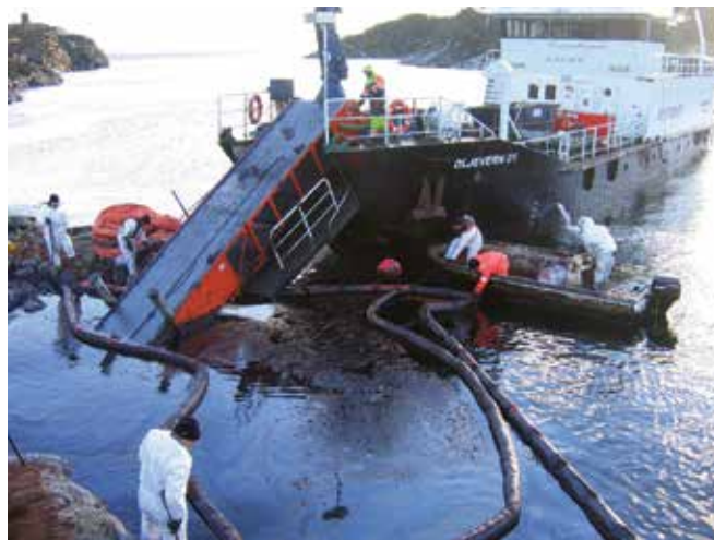
▲ 図15：大型回収船上のベルト式油回収機。ベルトはメッシュで作られていて、水は通り抜け、油の付着が促進される。油は船上に引き上げられ、掻き落されて貯蔵設備に入る。
