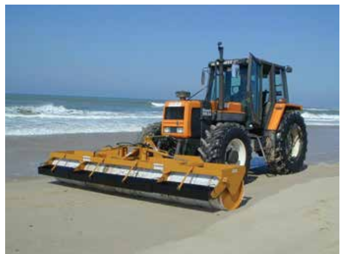
▲ 図36：トラクター搭載の親油性ドラム式油回収機。固く締った砂浜で新しいタールボールの回収に使用される。（画像提供：Le Floch Dépollution）
