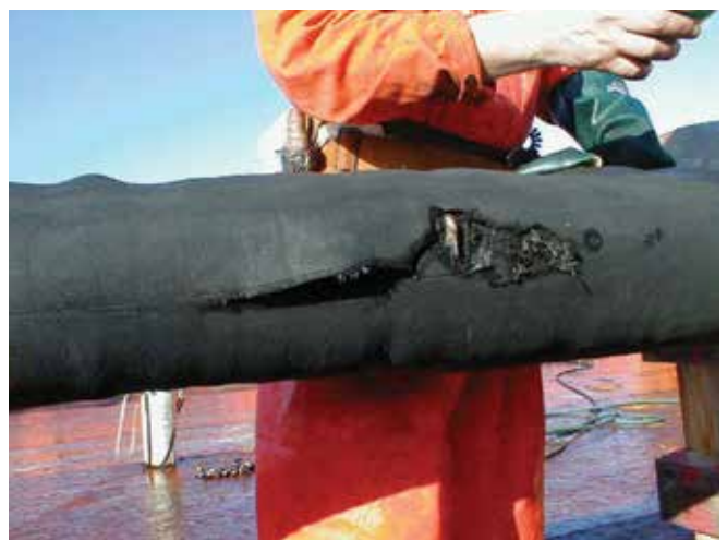
▲ 図23：高粘度油の移送によって内圧が高くなりすぎた結果、破裂したホース。（画像提供：NOFO）
