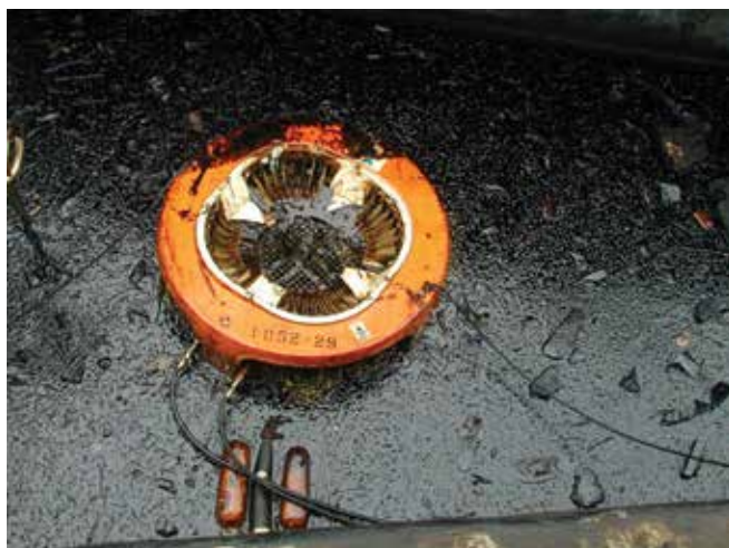
▲ 図2&3：小型の親油性ディスク式油回収機。中粘度油に適している。油は回転する円盤に付着し、掻き落されて油溜めに落ち、貯蔵設備へ送られる。適切なポンプと油圧動力供給を必要とする。
