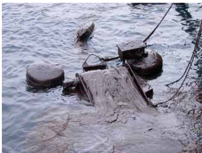
▲ 図16：乳化が進んだ重油中へ投入された堰式油回収機の能力増強のために付加されたベルト・アダプター。油が高粘度であるため、堰へ向かって流れること及び堰の縁を越えることができなかった。代わりに鋸状のベルト・アダプターが油を「掴み」、効率を上げ、更に油の凝集エネルギーによって、残った油が油回収機に向かって「流れる」ようになった。（画像提供：Ro-Clean Desmi及びデンマーク海軍）
