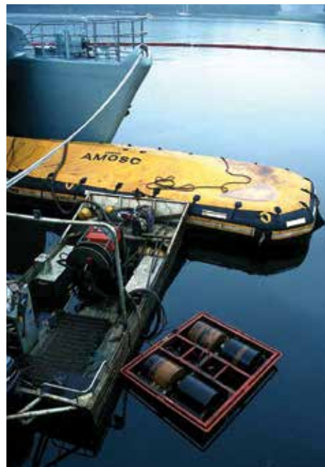
▲ 図26：充気式貯蔵用艇に油を回収中のドラム式油回収機。
