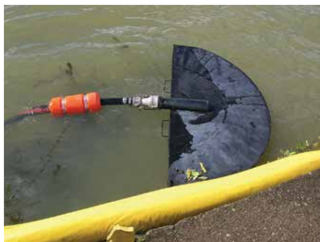
▲ 図11：真空ポンプに取り付けられた固定堰式油回収機。ヘッドの縁に多数の小さな入口があり、油を選択的に回収できる。ゴミが殆ど無い平水で使用する。（画像提供：Lamor）
