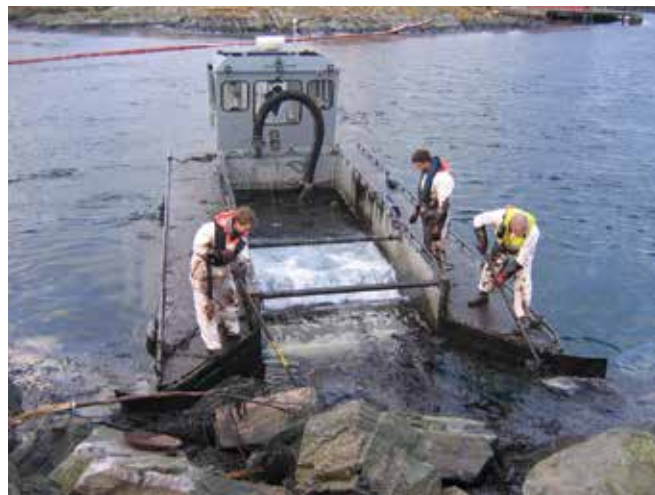
▲ 図34：岩の多い遮浪性の入り江で油を回収している自走型堰式油回収機。船の喫水が浅いため、海岸近くで作業できる。作業員がすべき油を堰の入口に向けて移動させている。
