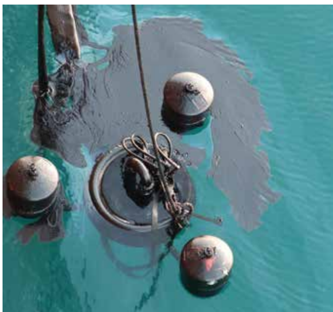
◀ ▲ 図12& 13：堰式油回収機は、油膜の上面直下にある中央の堰を重力の力によって乗り越えた油を選択的に回収する。回収された油は貯油部に入り、ポンプで貯蔵設備へ送られる。
