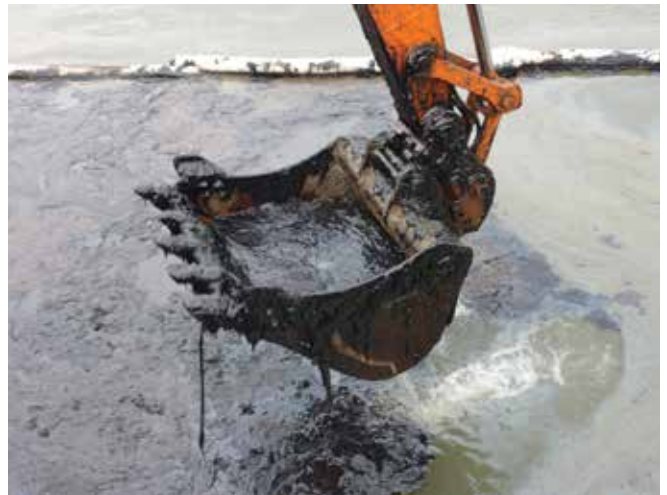
▲ 図21：高粘度重油の回収に掘削機を使用。作業員に、バケットを水面上でしばらく保持するように指示することにより、同伴水が排出され、回収油の濃縮度が最大になった。その結果、回収効率を犠牲にして、その後の処理費用を削減できた。
