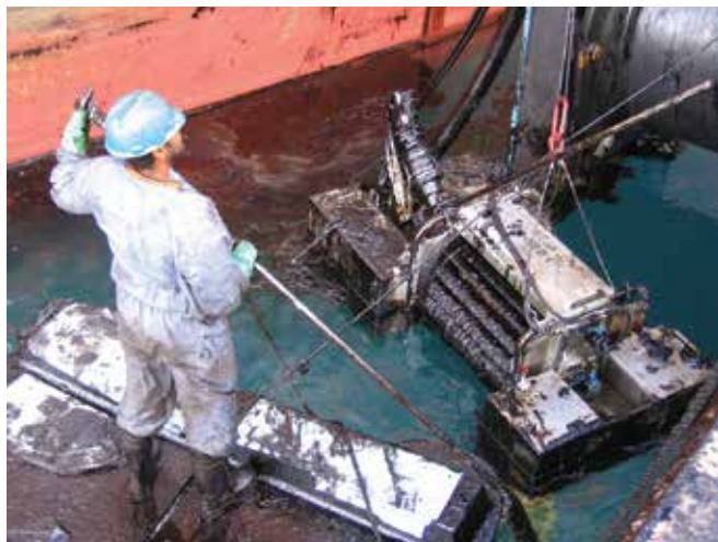
▲ 図17：港湾地区で展開される機械的ドラム式油回収機。回転するドラムの歯が油を装置へ引き寄せ、油はドラムの中に回収され、貯蔵設備へ送られる。ドラムは、水の回収を最小限にするためにメッシュで作られている。
