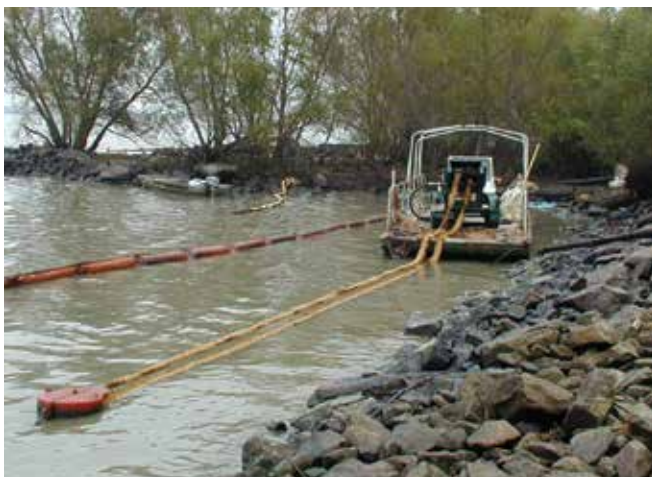
▲ ▶ 図6&7：水平及び垂直型親油性ロープ式油回収機。より合わせた吸着環が連続するモップを形成している。水面に浮いているモップに油が付着する。モップはローラーまで引き戻されて、油は圧搾され、貯蔵タンクに入る。ロープ・モップ式油回収機は、ゴミ、氷、その他の障害物の中にある油を回収するのに役立つ。
