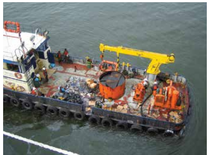
▲ 図24：甲板上の回収油貯蔵容量が限られている作業船。
