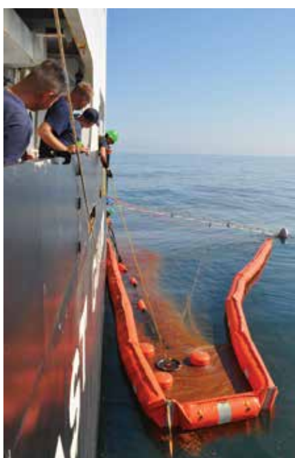
◀ 図31：アウトリガーに取り付けられた充気式オイルフェンスと大容量自由浮遊型堰式油回収機で構成され、沿岸警備隊の船艇に搭載された単船回収システム。フリーボードが高いため、比較的静かな水域で風下側で展開できる。(画像提供：USCG)
