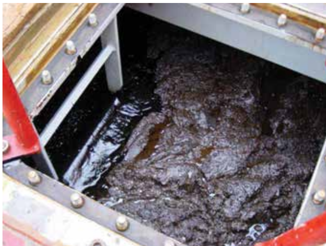
▲ 図25：回収船上の貯蔵タンク内の高粘度回収油。（画像提供：NOFO）
