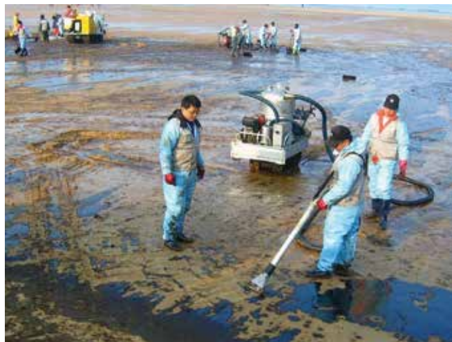
▲ 図9：可搬式真空吸引システムの使用により、砂浜や磯での油回収が容易になる。コンパクトなシステムは貯蔵容量が限られるが、他の方法では近づきにくい場所での作業が可能である。
