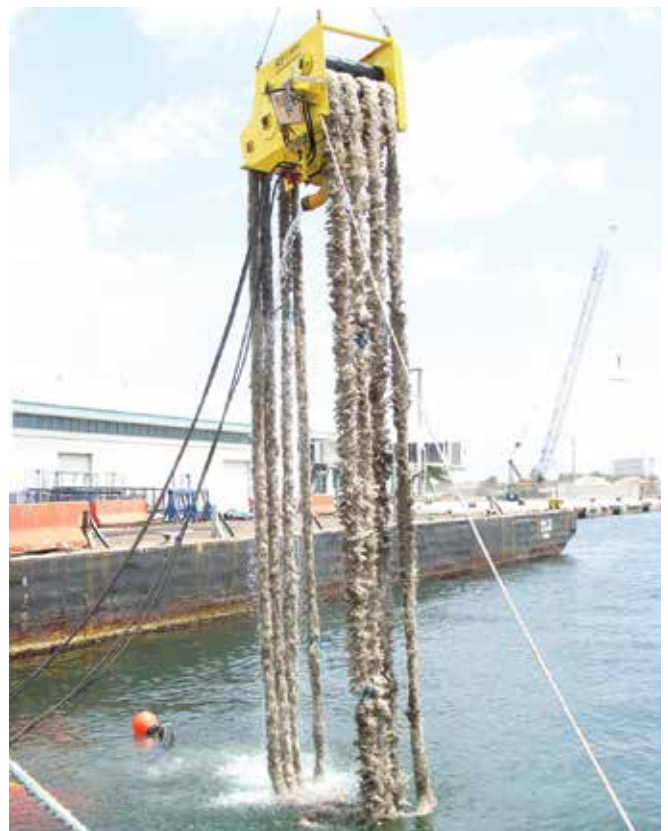
▲ 図5：自由浮遊ブラシ式油回収機。油は回転するブラシ・セットに付着し、水面から引き上げられる。油は櫛でブラシから掻き取られ、貯蔵設備へ送られる。ブラシの背後のプロペラが浮遊油を油回収機の方に引き寄せることにより、遭遇率と処理量を高める。（画像提供：Lamor）
