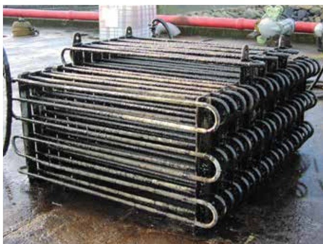
▲ 図27：回収船から陸上への高粘度油の排出を良くするために使用される可搬式加熱コイル。
