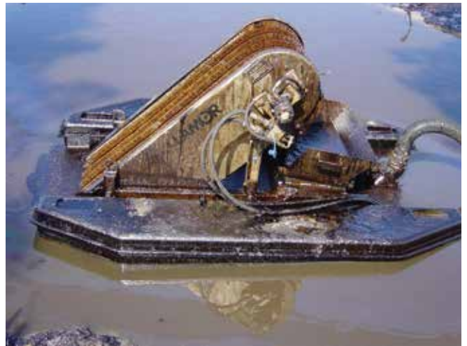
▲ 図5：自由浮遊ブラシ式油回収機。油は回転するブラシ・セットに付着し、水面から引き上げられる。油は櫛でブラシから掻き取られ、貯蔵設備へ送られる。ブラシの背後のプロペラが浮遊油を油回収機の方に引き寄せることにより、遭遇率と処理量を高める。（画像提供：Lamor）
