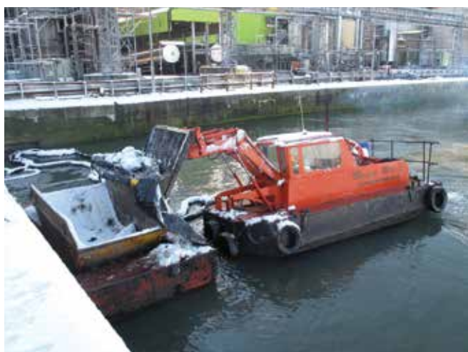
▲ 図35：通常は港湾内でゴミの回収に使用される自走船。ここでは気温が低く、油の流動点が比較的高いため、油が半固体になり、スcoopとグラブで油を海上の大型ゴミ容器に回収する必要があった。
