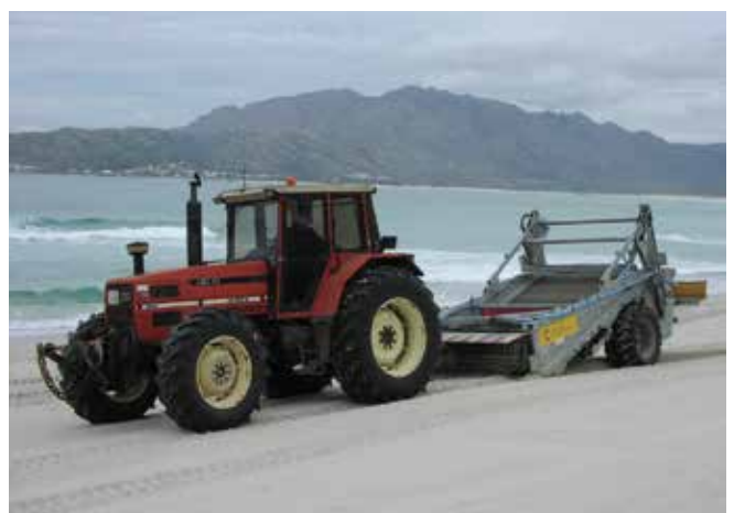
▲ 図26：タールボールを回収中の、トラクターに牽引されるビークリーナー。
