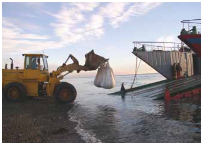
▲ 図11：1トンの「ビッグバッグ」にまとめられた、油で汚染された廃棄物の小袋が、孤立した海岸から除去するために、上陸用舟艇へ移される。
