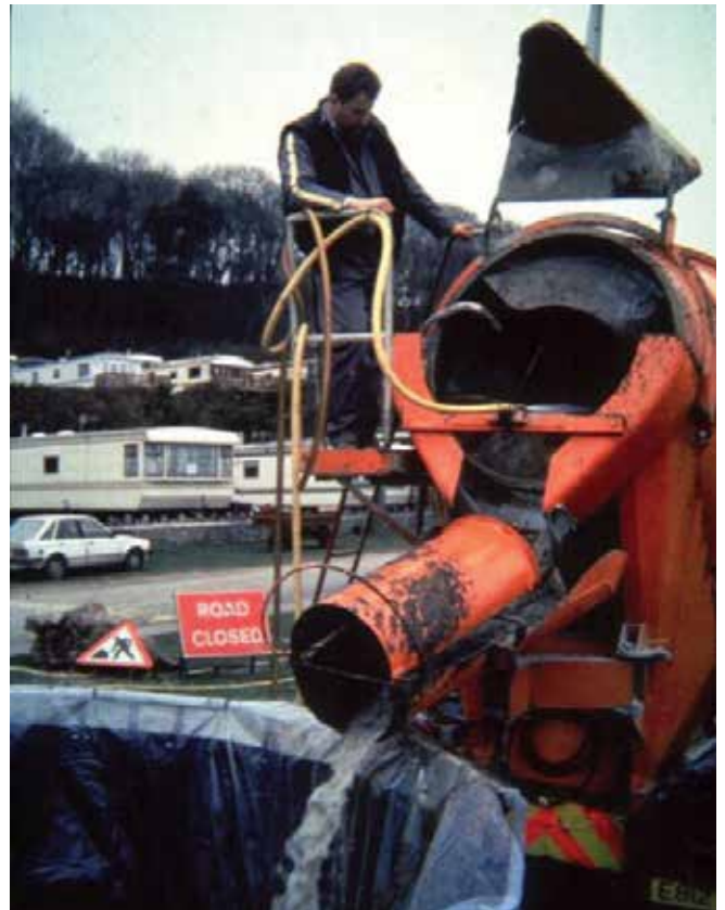
▲ 図24：中礫と小さめの大礫を洗浄後、コンクリートミキサー車から放出される排液。
