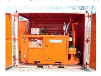
クレーン、DOP-250型移送ポンプ、 そしてパワーパックをコンパクトに 一体化させた新しいシステム。 簡易回収タンクあるいは回収油ピットからの 油の移送、また、海岸まで押し寄せた 流出油の回収作業にも対応できる。 最大移送(回収)能力:100kl/時。 10ftコンテナ(3.0m長×2.5m幅×2.5m高)に すべてを収納。総重量約3.5トン。
