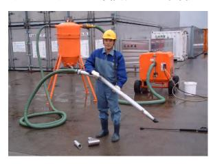
バキューム式の海岸漂着油回収用のクリーナー。 吸引作業と同時に使用可能な高圧洗浄水用ポンプを装備。 回収能力約30kl/時、動力はディーゼルエンジン。 ビーチクリーナー一式 (本体、油貯留ホッパー、ホース類などで構成) 2組を専用コンテナに収納 (3.0m長×2.4m幅×2.6m高)、 総重量は4トン弱。 あわせて同コンテナに木箱収納の 仮設回収タンク8基を収納。
